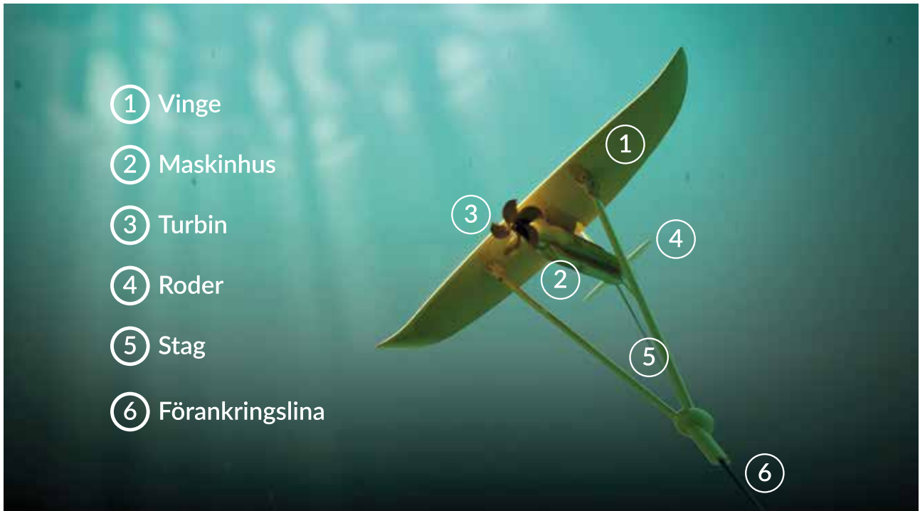
Bild 10. Ett Deep Green-kraftverks huvudsakliga delsystem. Bild: Minesto
